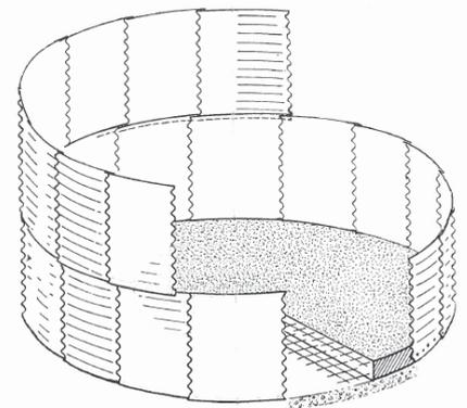
La estanqueidad permanente se realiza mediante cintas plásticas colocadas entre las uniones de las placas durante el montaje.
